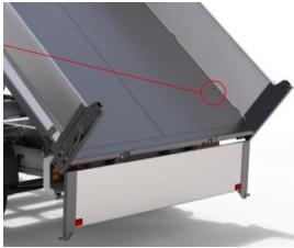
Benne acier basculante avec anneaux d'arrimage
