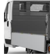
Ridelles lat. aluminium ouvrantes à 180° H = 400 mm
