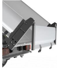
Ridelle arrière à 2 positions, déverrouillage automatiquement dès inclinaison 20°
