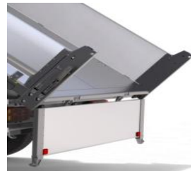
Ridelle arrière à 2 positions, déverrouillage automatiquement dès inclinaison 20°
