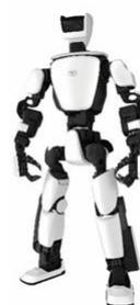
Lancé par Toyota en 2017, le T-HR3 est un robot humanoïde capable d'effectuer en souplesse les mêmes mouvements que son télémanipulateur humain. Par retour de force, il sait aussi partager avec ce dernier la force exercée par et sur le robot.
